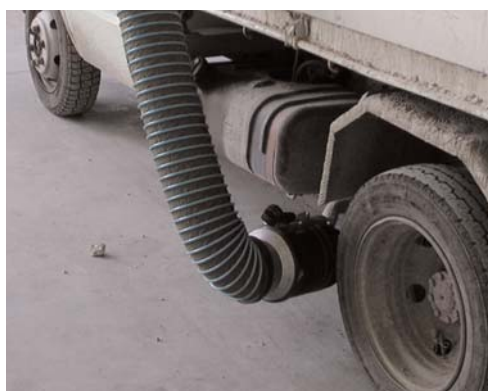
Particolare della bocca di aspirazione collegata alla marmitta del veicolo.
