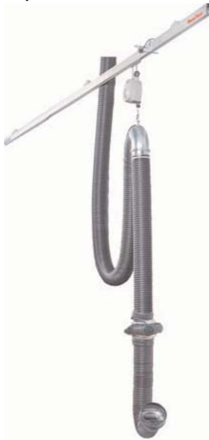
*Tubo di aspirazione mantenuto sollevato da un bilancino che scorre lungo la canalina-guida.
