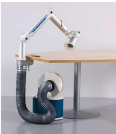
Kit di aspirazione progettato per una postazione di lavoro, dove si richiede una portata fino a 150 m<sup>3</sup>/h. Il Kit è composto da un braccio di aspirazione serie BT con giunto girevole e supporto a banco, un gruppo-filtro con elettroventilatore, un tubo flessibile di raccordo e una bocchetta.
