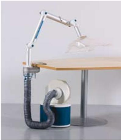
Kit di aspirazione progettato per una postazione di lavoro, quando è necessaria una portata fino a 100m<sup>3</sup>/h. Il Kit è composto da un braccio di aspirazione serie BT a 3 snodi facilmente regolabili, completo di serrandina e supporto a banco, un gruppo-filtro con elettroventilatore, un tubo flessibile di raccordo e una cappa multifunzione.
