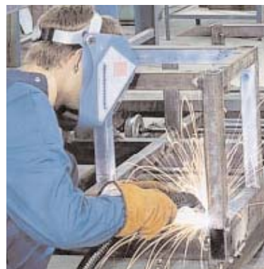
Aspirazione di fumi di saldatura direttamente dalla torcia
