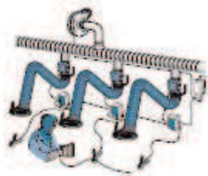
*Bracci di aspirazione collegati ad una canalizzazione completa di elettroventilatore. Avvio/arresto automatico dell'elettroventilatore e controllo delle serrandine.*
