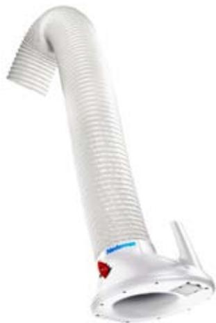
Braccio aspirante snodato, progettato specificatamente per aspirare fumi, vapori o polveri non esplosive. Il braccio aspirante ha un'elevata resistenza alla corrosione in quanto tutti i componenti in alluminio, incluso il pantografo, sono anodizzati. Indicato nell'industria alimentare, chimica, farmaceutica e per tutte quelle applicazioni che richiedono un braccio aspirante resistente alla corrosione e facile da posizionare.
