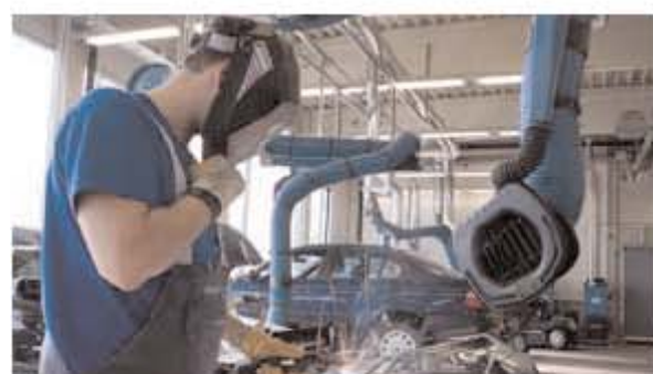
Aspirazione di fumi di saldatura Ampia gamma di bracci di aspirazione in diversi modelli e lunghezze. Possono essere abbinati a canaline di scorrimento o a bracci a bandiera per aumentarne il raggio d'azione.
